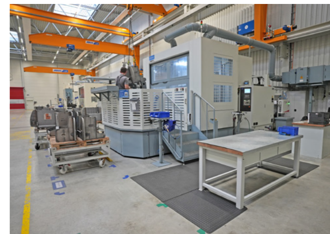
Mechanische bewerking van het staaldradtakelframe op 4-assige freescentra
